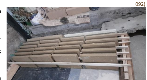
Figura 090 Prensa con gato hidráulico de 50 ton. Figura 091 Rotura de panel por transporte. Figura 092 Curado de paneles BTC.
