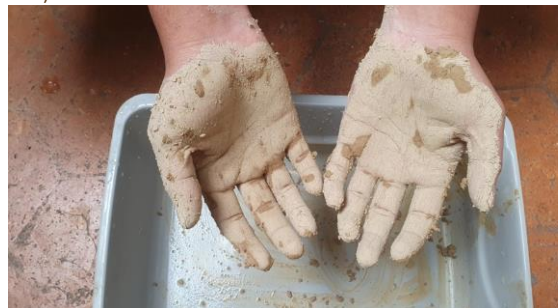
Figura 077 Ensayo de olor. Figura 078 Ensayo de mordedura. Figura 079 Ensayo de lavado.
