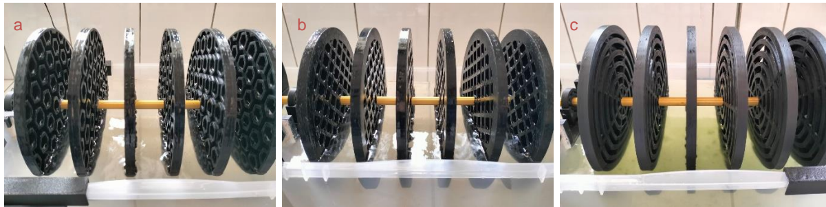
Imagen 5. Etapas del sistema con diferentes diseños de disco a) Etapa 1: microorganismos eficaces, b) Etapa 2: microorganismos eficaces y c) Etapa 3: algas Chlorella .
