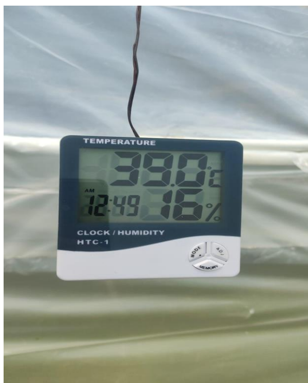
Figura 9. Higrómetro HTC1 utilizado para el monitoreo dentro del invernadero.
