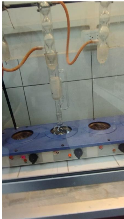
G.4. Extracción de grasas por Soxhlet
