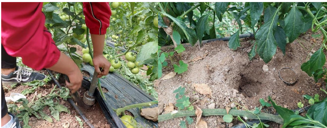
Extracción de muestras para densidad aparente del suelo con anillos.
