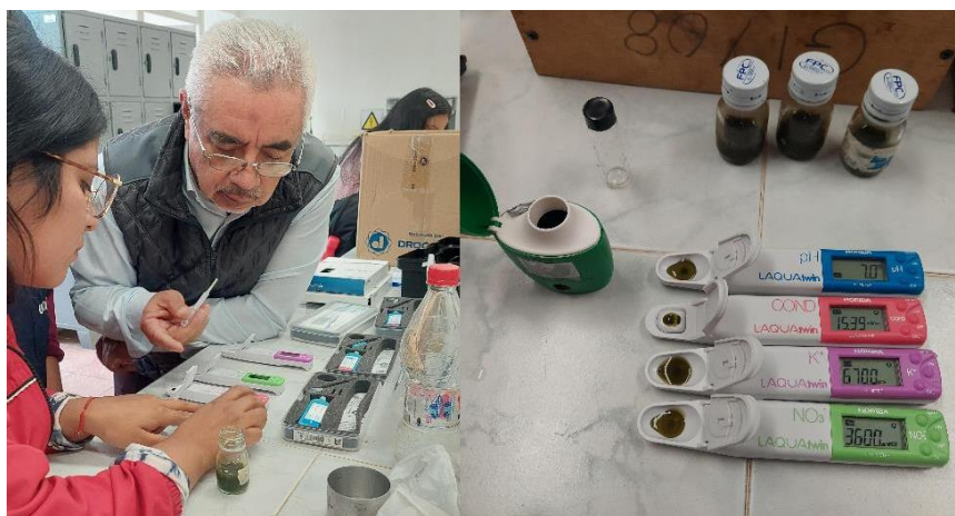
Determinación de nitratos ( \text{N-NO}_3^- ), potasio (K), fósforo (P), conductividad eléctrica (CE) y pH en savia de peciolo.
