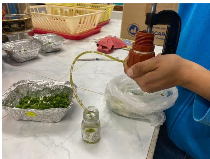
Figura 5. Extracción de savia de pecíolos mediante prensa manual durante el muestreo en invernadero
