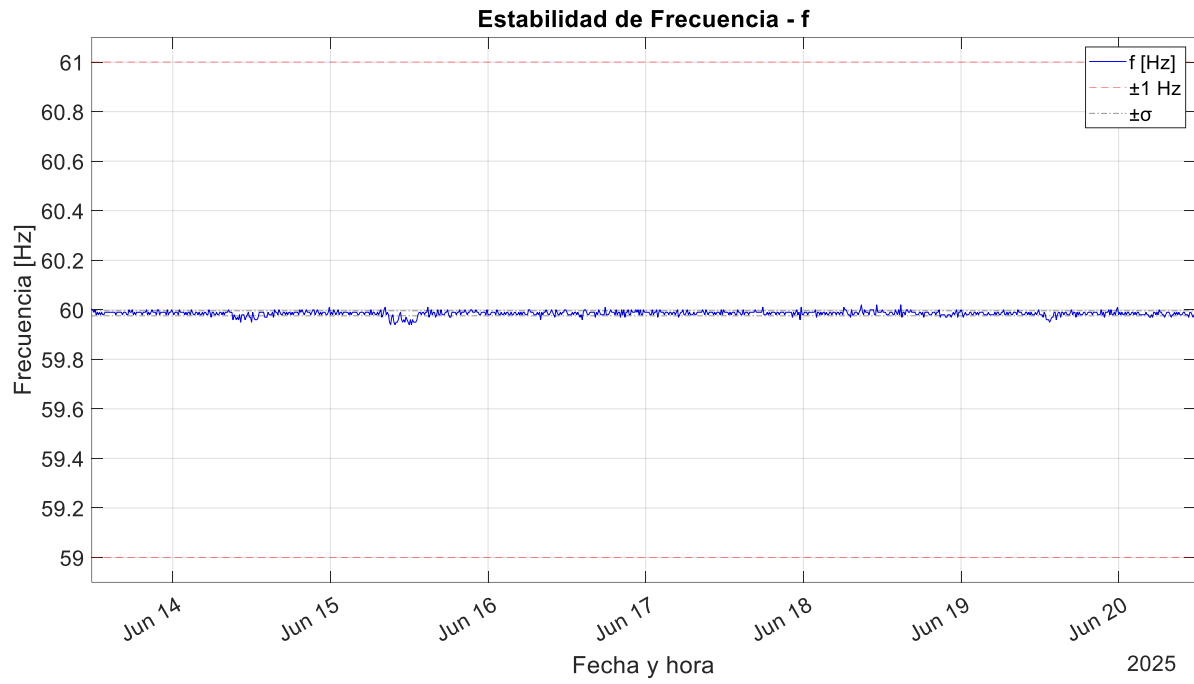
Figura 34. Curva del registro de variación de frecuencia para el SFV del Laboratorio de Micro-Red. Fuente: elaboración propia (2025).
