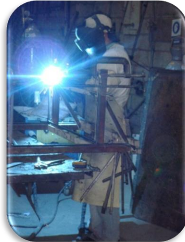
FOTO 7.1.- Soldado de estructuras
