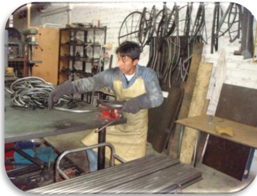
FOTO 5.1.- Doblado de tubos Fuente: Autor, Octubre 2011
