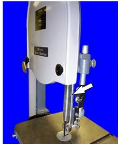
Protección ajustable en hoja de sierra
