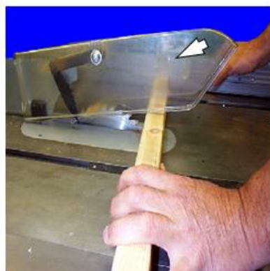
Protección auto ajustable de sierra circular de mesa
