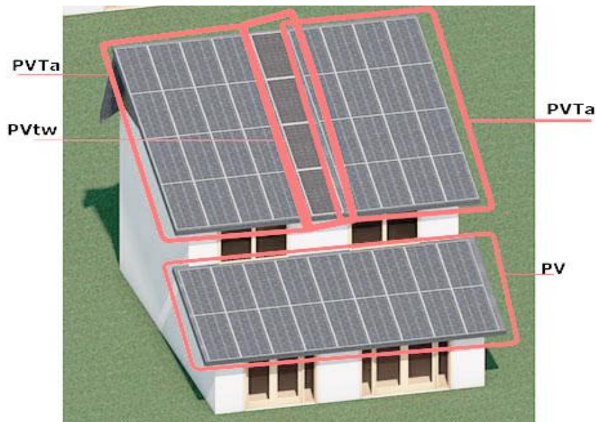
Figura 9 - Instalación de tecnologías híbridas conjuntas BIPVTa más BIPVTw, complementado con BIPV en Modelo C
